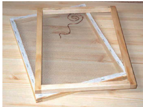
Abb. 10: Siebrahmen mit zusätzlichem Wasserzeichen und Deckelrahmen
